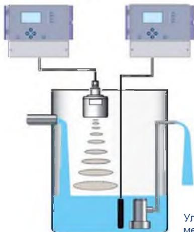
Ультразвуковое и пьезометрическое измерение уровня
