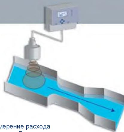
Измерение расхода в канале Вентури
